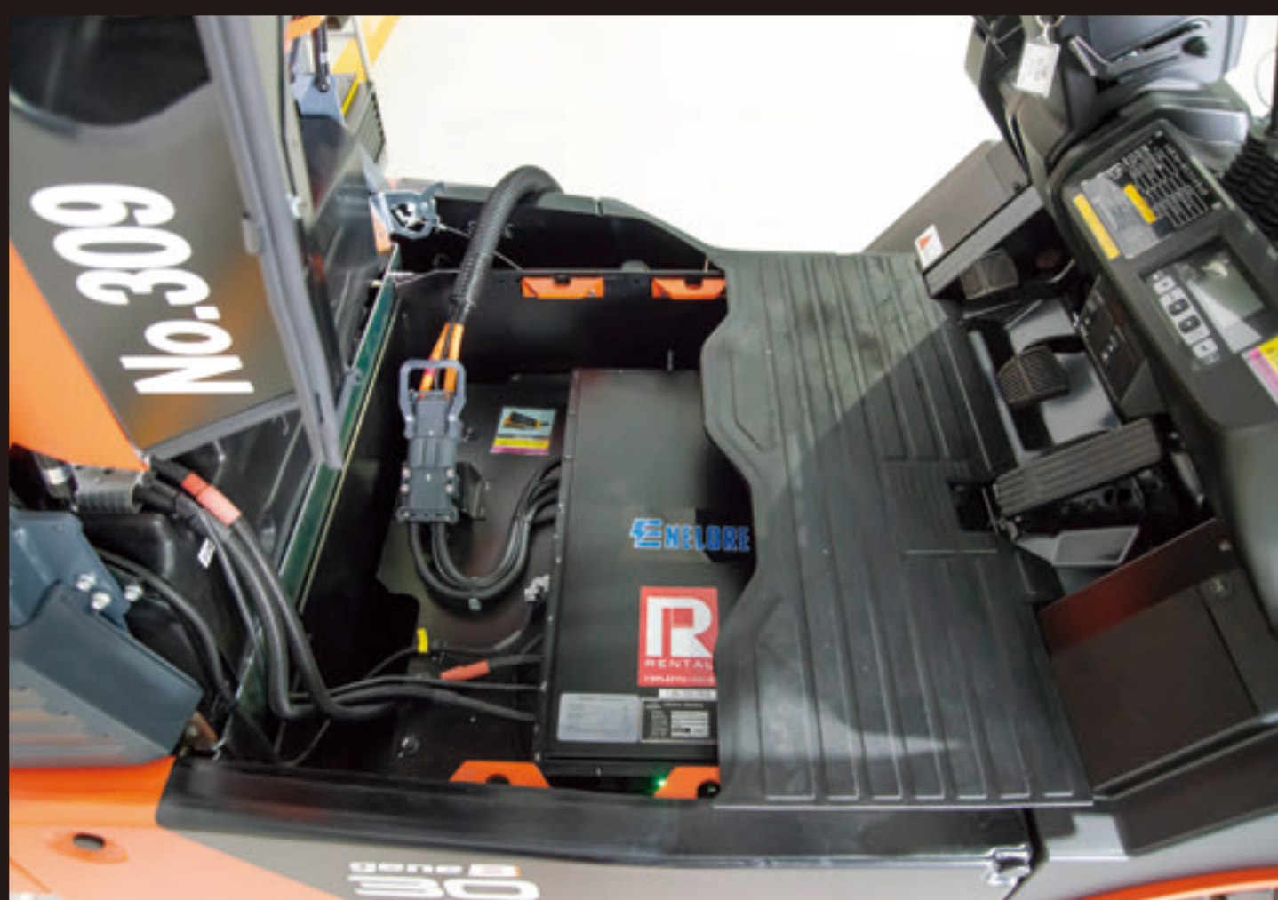
③ 機台に搭載されたENELORE®補水作業が不要で、バッテリー管理の手間とコスト削減に貢献。
