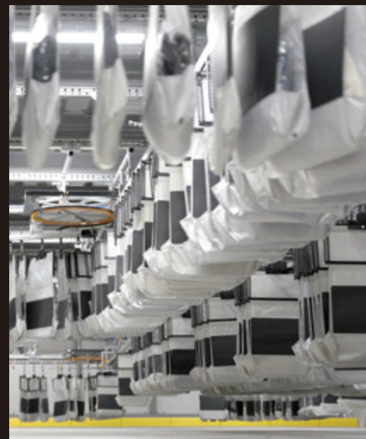
③仕分け・順立てエリア 商品が揃ったら、仕分けエリアに搬送され、出庫指示順となるように仕分けします。レーン毎にシーケンスグループを格納した後、順立てエリアにて順立てされます。
