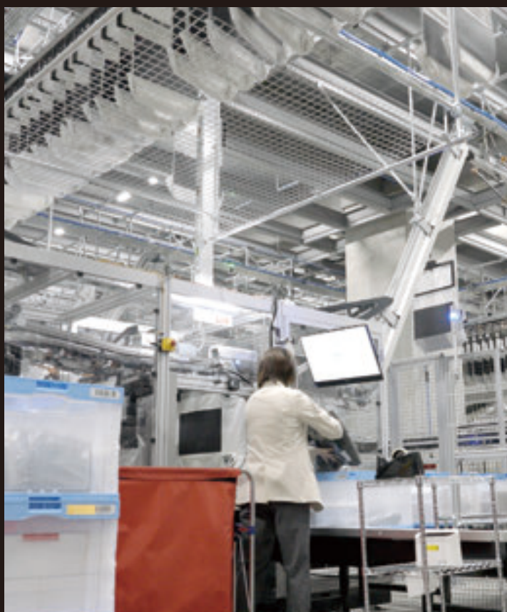
①入庫ステーション ピッキングされた商品を積載したオリコンがコンベヤで各入庫ステーションに供給された後、作業者が商品をスキャンし、ポケットに投入。定点作業で腰曲動作がなく、作業者の身体的負担を軽減しています。
