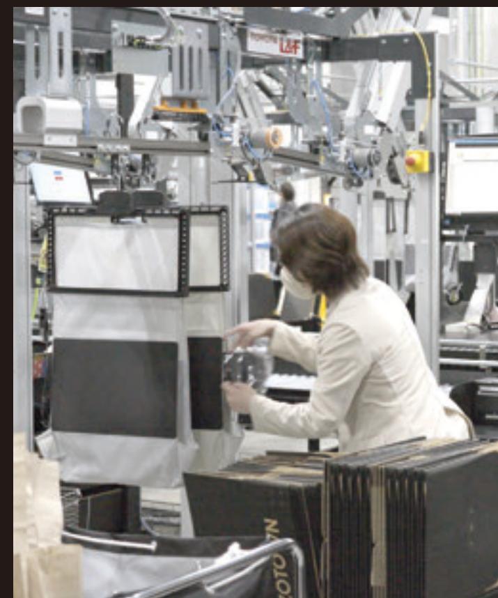
④出庫ステーション 順立てされたポケットは、出庫・ピッキングステーションに搬送され、作業者が商品をポケットから取り出して、出荷検品を行い、箱詰めします。
