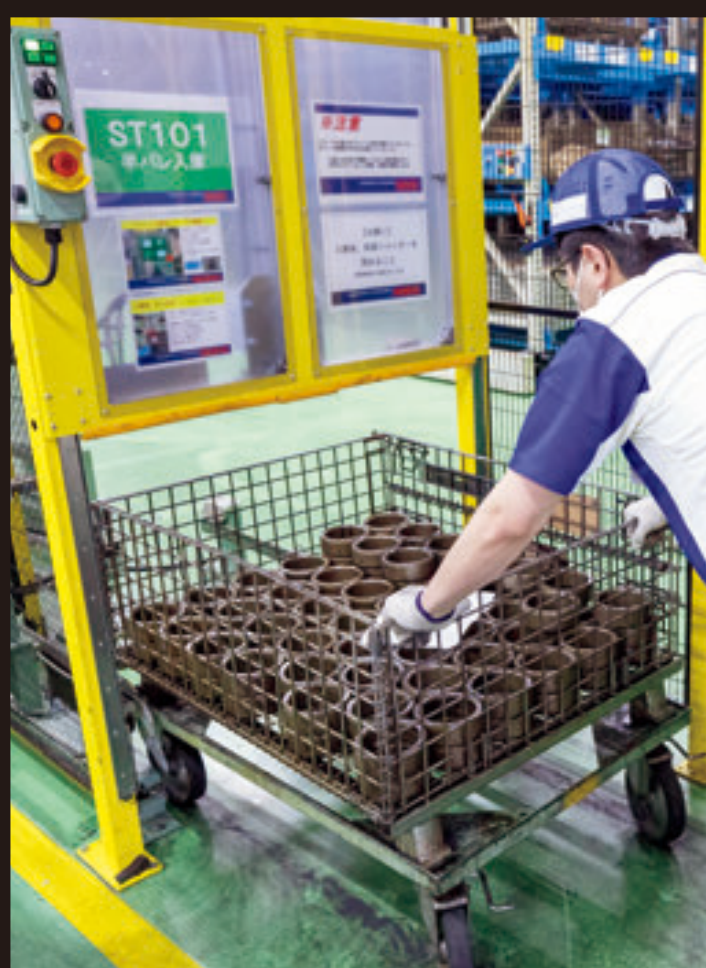
①入庫準備 作業者がパレットのバーコードを読み取り、所定の荷取り位置にセット。
