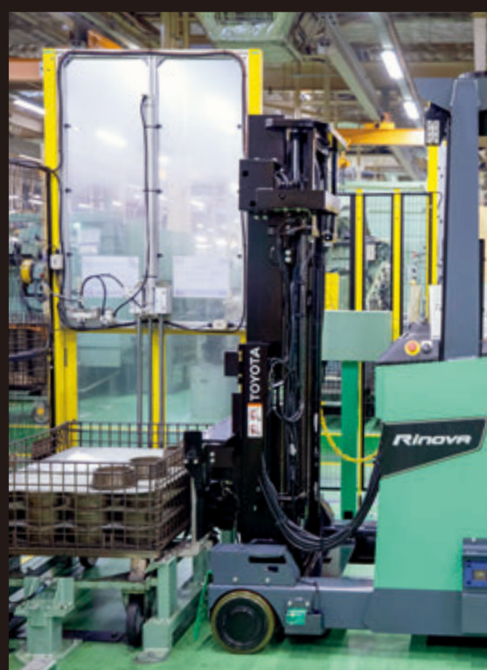
③出庫 倉庫制御システムIS-200で作業者が出庫品番を入力し、台車を荷置き位置にセット。入庫時と同様に、AGFが移動ラックと連動し、自動でパレットを出庫。
