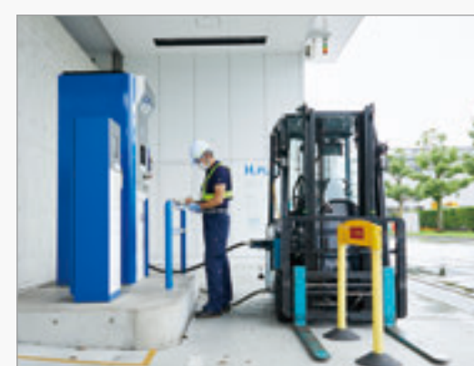
FCフォークリフトへの水素充填 (充填時間は約3分)
