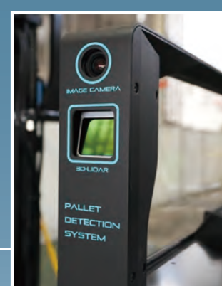
【パレット検知】 カメラ+3D-LiDAR
