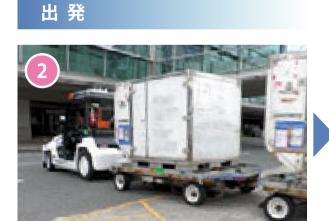
航空機より降ろされたコンテナを、作業者に 積み込み後、無人搬送開始。
