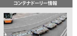
[概略寸法]L3,800×W1,800×H543mm [最大積載]2,500kg/[ドーリー種類]2種類以上
