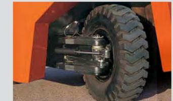
\*Full Hydraulic Power Steering (全油圧式パワーステアリング)
