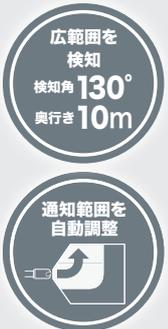
水平検知角130°、奥行き最長約10m、左右各約5.5mの広い範囲を検知可能。さらに、検知対象の種類・車速・進行方向によって通知範囲を自動調整することで、お客様の作業への影響を抑えることが可能です。
