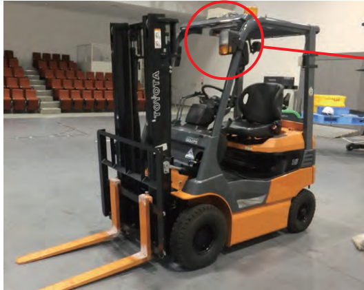
磁界送信アンテナ【一体型検知機】 (運転席上部に設置)
