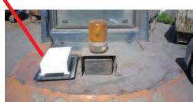
アンテナ②(運転席後部に設置)
