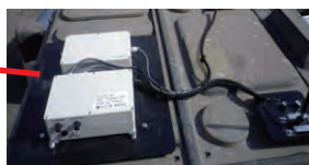
アンテナ①(写真上) 分離型検知機(写真下) (運転席上に設置)
