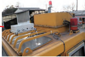
磁界送信アンテナ【一体型検知機】 (運転席上部に設置)
