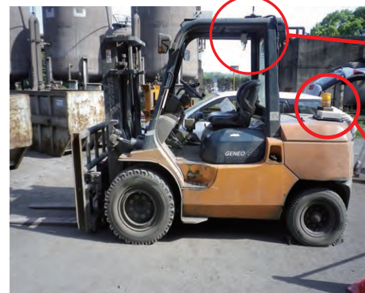
アンテナ①(写真上) 分離型検知機(写真下) (運転席上に設置)
