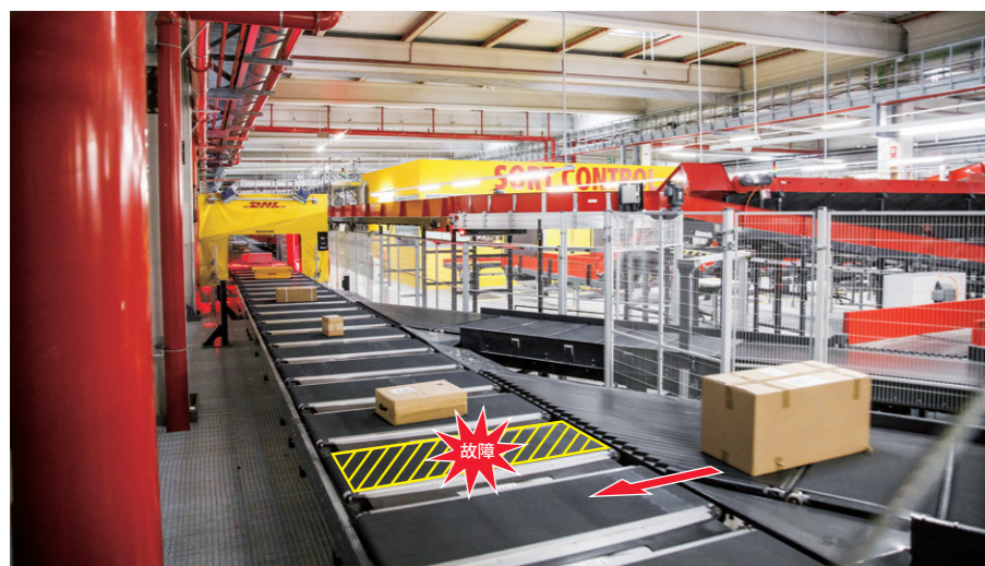
故障したセルユニットは使用せず、他のセルユニットで稼動を維持可能
