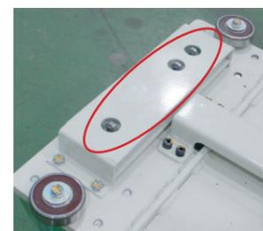
台車側発進・停止・緊急非常停止入力用リミットスイッチ
