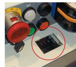
待機制御や分岐制御に使用できる4Bit光通信ユニット(オプション)
