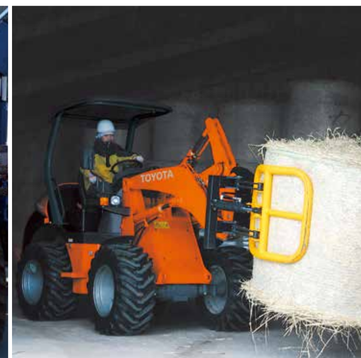
ロールグラブ 曲線アーム形状により、ラッピングロールなどを 傷つけることなくスピーディに運搬できます。
