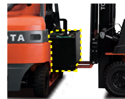
※フレーム右側はサイドカバーはありません。また、標準版车型に比べ全高が80mm高く、最低地上高が15mm低くなります。
