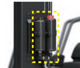
マスト左側面にアクムレーターを2つ搭載し、フォークの振動・衝撃を吸収
