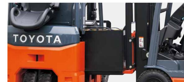
バッテリー下部にフォークポケットを設け、フォークリフトでバッテリー交換可能な仕様を設定。一括補水装置付バッテリーにも設定可能。※標準車より最低地上高が12.5mm低くなります。
