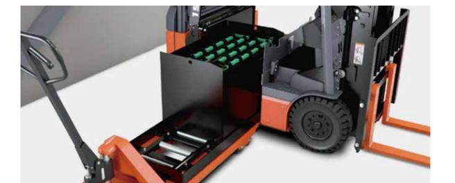
ホイストクレーン等の設備がなくてもバッテリー交換が可能なバッテリーロールアウト仕様を設定。※別途バッテリーキャリアが必要です。標準車より最低地上高が12.5mm低くなります。
