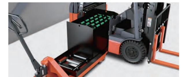
ホイストクレーン等の設備がなくてもバッテリー交換が可能なバッテリーロールアウト仕様を設定。
