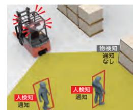
カメラによって、障害物の中から人を見分け、人を検知した場合のみ通知・車両制御する、作業への影響に配慮した設定が可能です。また、作業者はタグを持つ必要がないため、不特定の人が出入りする現場の安全作業に貢献します。
