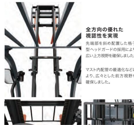
バックレストのロアステー斜め配置や小径ハンドルの採用、ディスプレイのインバネ配置などにより、すっきり見やすいフォーク先端視野を確保しました。
