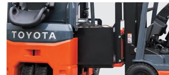
バッテリー下部にフォークポケットを設け、フォークリフトでバッテリー交換可能な仕様を設定。一括補水装置付バッテリーにも設定可能。
