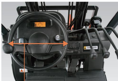
ステアリング径 **300mm** 従来車比-60mm
