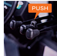
ティルトレバーのノブスイッチを押したまま前傾操作すると、水平位置でフォークが自動停止
